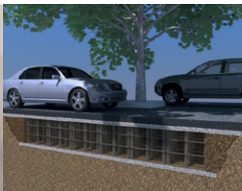
Obr. 4: Využití prokořenitelných buněk v rámci obnov stromořadí ve městech
